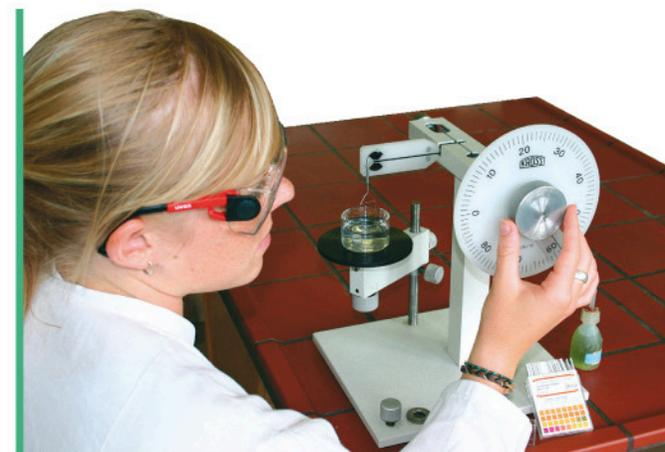
Messung der Oberflächenspannung
