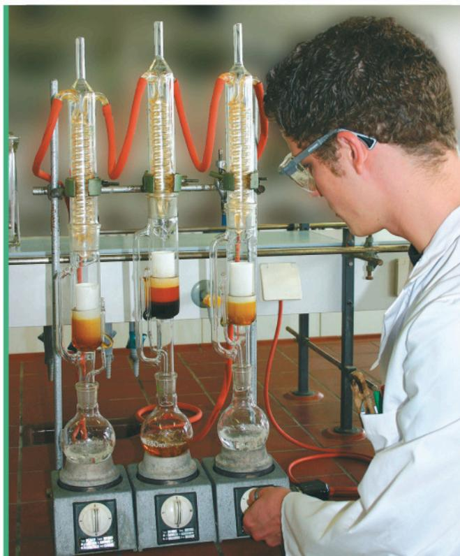
Extraktion von Stoffen mit einer Soxhlet-Apparatur
